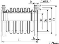
Компенсаторы сильфонные неразгруженные осевые типа НОВГ с фланцами и направляющим патрубком.
