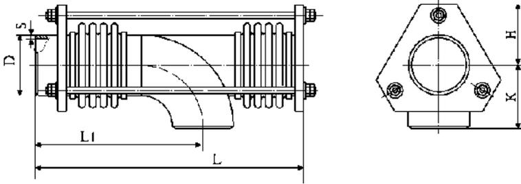
Компенсаторы сильфонные разгруженные универсальные типа 2РУОП. Данные компенсаторы могут устанавливаются непосредственно в трубопроводы, проводящие воду (сетевая и питьевая) с температурой до 150 °С и скоростью до 8 м/с, а также пар и газообразные среды, не вызывающие коррозию материалов компенсатора с температурой до 500 °С и скоростью до 20 м/с.
