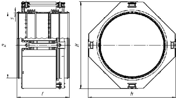
Компенсаторы сильфонные типа 2СППМ. Данные компенсаторы могут устанавливаться непосредственно в трубопроводы и паропроводы, проводящие воду с температурой до 150 °C и скоростью выше 8 м/с, а также пар и газообразные среды, не вызывающие коррозию материалов компенсатора с температурой до 500 °C и скоростью от 20 до 80 м/с.
