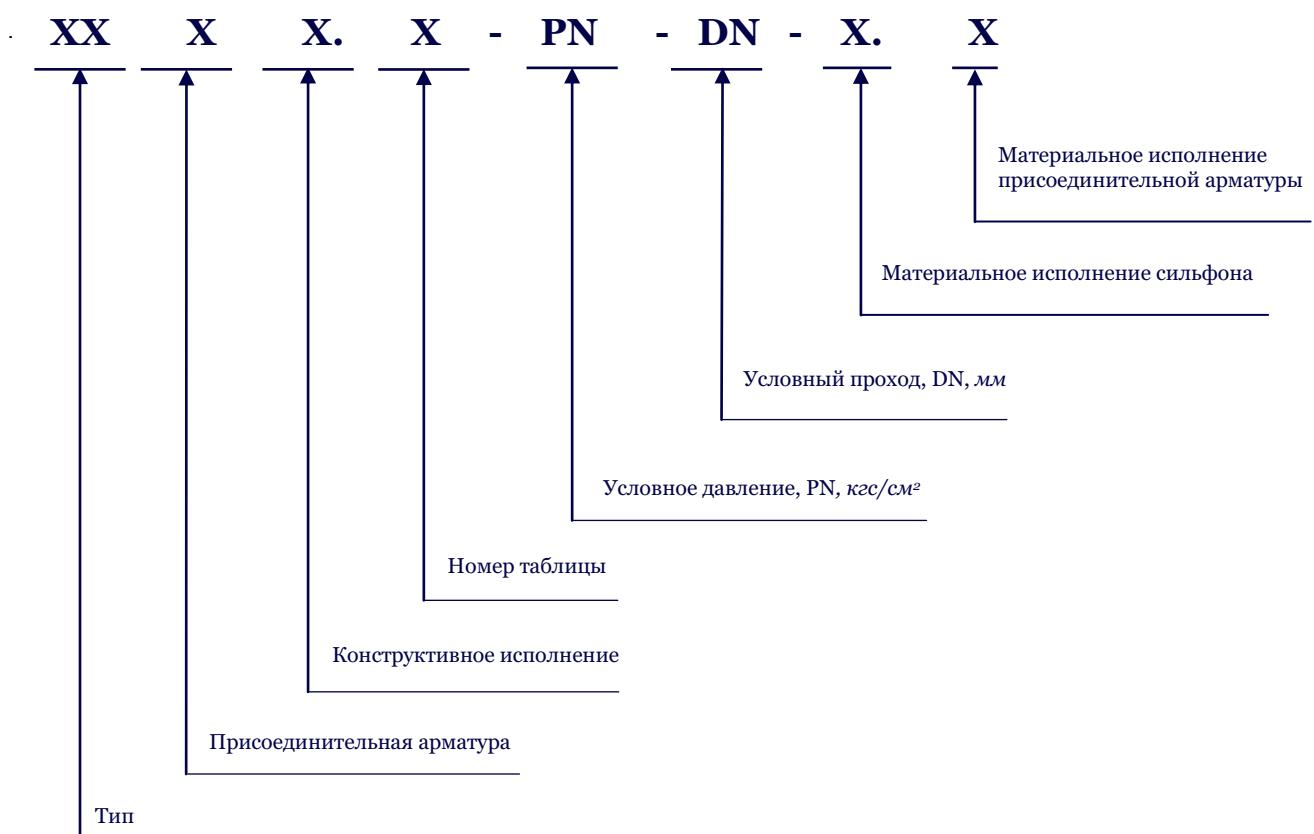
В зависимости от условий эксплуатации, материальное исполнение сильфонных компенсаторов должно оговариваться при заказе в соответствии нижеприведёнными таблицами:
