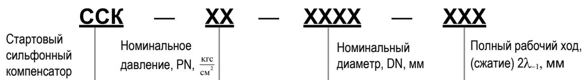
**Конструктивные особенности сильфонных компенсаторов и стартовых сильфонных компенсаторов
