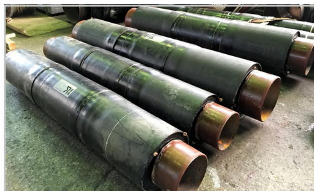
Герметичность установки мембраны контролируется при изготовлении выдержкой под давлением  $0,5 \text{ кгс/см}^2$ . Это позволяет гарантировать полную защиту сильфона и теплоизоляции от проникновения грунтовых вод в течение всего срока службы СКУ. Сама мембрана защищена от грунта и песка плотно набитой сальниковой набивкой. Тем самым в новой теплогидроизолированной конструкции СКУ предусмотрена двухуровневая защита наружной поверхности сильфона и конструкции СКУ в целом.
