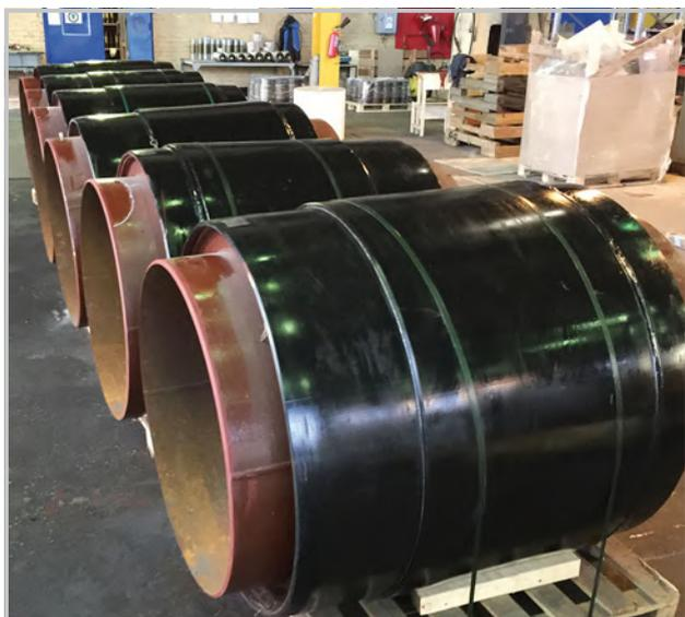
3.5.4.12. Для установки термоусаживающихся или электросварных полиэтиленовых муфт на стыки компенсационного устройства с полиэтиленовой оболочкой теплоизоляции трубопровода в конструкции компенсационного устройства предусмотрены установленные на цилиндрических направляющих устройства термоусаживающиеся муфты, по наружному диаметру соответствующие диаметру полиэтиленовой оболочки трубопровода, а по длине — достаточные для качественной установки муфты.
