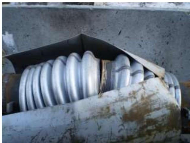
*Рис. 3,4,5. Изгиб трубопровода с сальфонным компенсатором, установленным по схеме 1. На рис.5 изображен разрыв однослойного компенсатора – крайне неустойчивой и ненадежной конструкции для тепловых сетей.*
