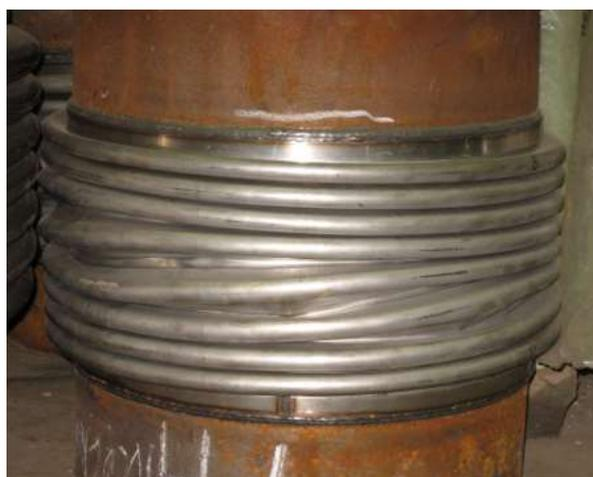
*Рис 2. Потеря локальной устойчивости сифонным компенсатором. (Испытания).*
